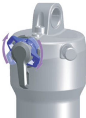
123. ábra: A nyomásfokozat-beállító keményebb beállítása
