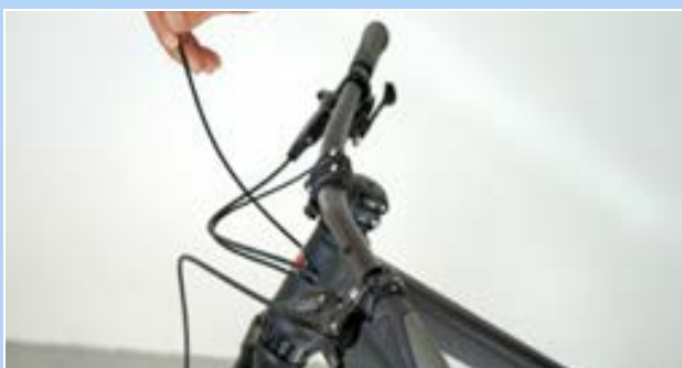
226. ábra: Végsapka beakasztása
