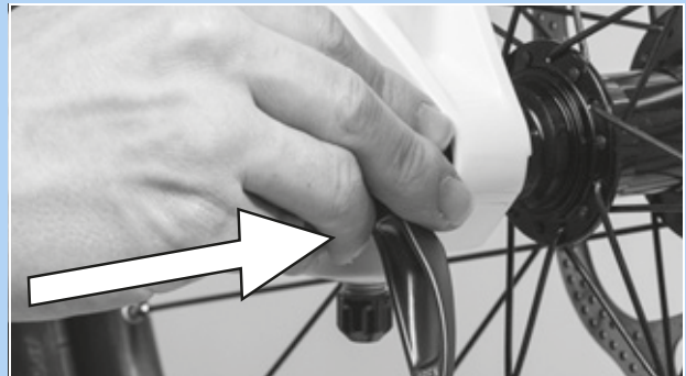
64. ábra: A gyorsár betolása nyilirányban
