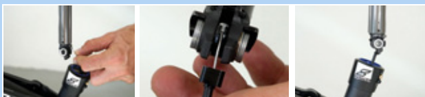
225. ábra: A nyeregcső felakasztása és betolása
