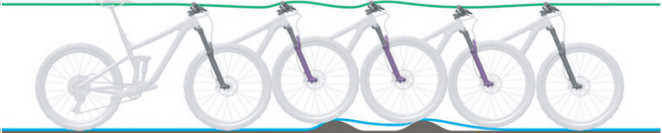
239. ábra: A teleszkópos villa túl lassú kirugózása
