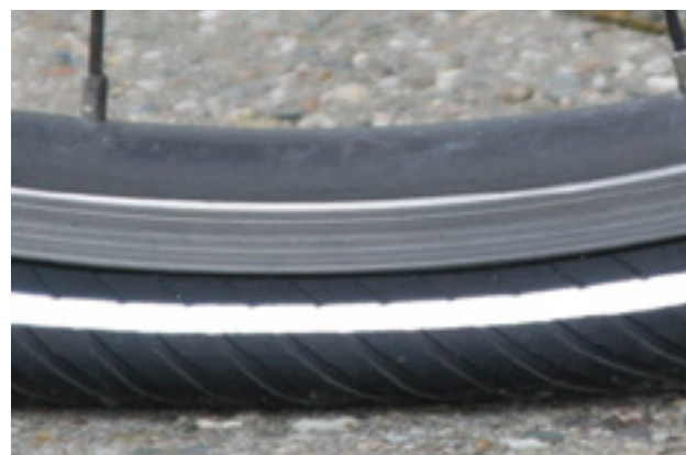
95. ábra: Túlontúl alacsony töltőnyomás
