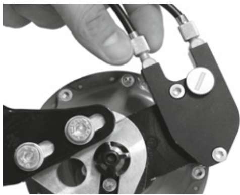
160. ábra: Külső váltóvezérléssel rendelkező Rohloff agyváltozatok húzásbeállítója a kötéldobozon van, ami a bal oldalon található
