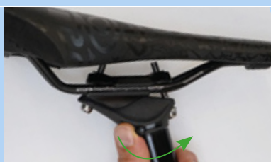
218. ábra: Magasságállítás nyitása
