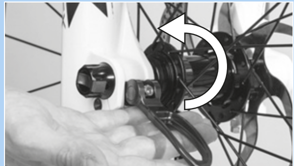
60. ábra: A gyorsár nyomása nyírányban
