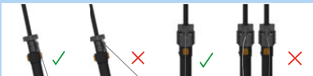
194. ábra: Helyesen és hibásan beállított bovdent
