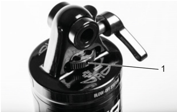
248. ábra: Suntour kerék húzófokozat-beállító (1) a hátsó lengéscsillapítón
