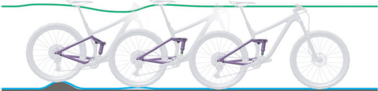
245. ábra: A hátsó lengéscsillapító túl gyors kirugózása
