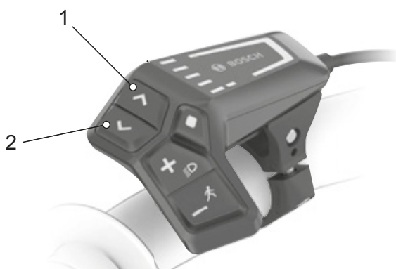
Afbeelding 139: Locatie toets helderheid verhogen (2) en toets helderheid verminderen (1)
