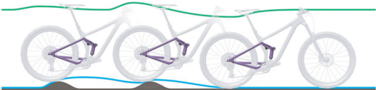
Afbeelding 247: Te langzaam uitveren van de achterbouwdemper
