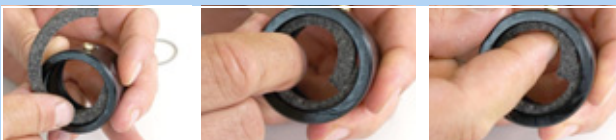
Afbeelding 215: Vilten ring inleggen
