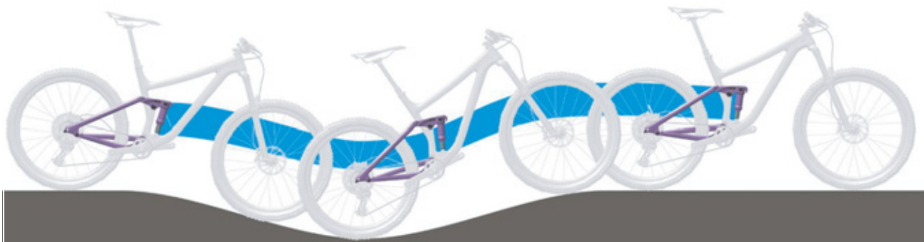
Afbeelding 21: Optimaal rijgedrag van de achterbouwdemper in heuvelachtig terrein
