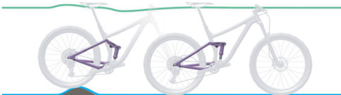
Afbeelding 17: Optimaal rijgedrag van de achterbouwdemper bij oneffenheden
