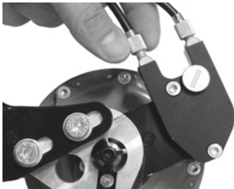
Afbeelding 160: Bij Rohloff naafversies met externe schakelaansturing zit de kabelafsteller op de kabelbox aan de linkerkant.
