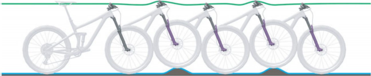
Afbeelding 8: Optimaal rijgedrag van de vork
