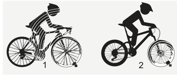
Afbeelding 7: zonder vering (1) en met vering (2)
