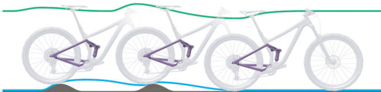
Afbeelding 255: Te langzaam uitveren van de achterbouwdemper
