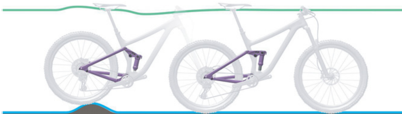
Afbeelding 119: Optimaal rijgedrag van de achterbouwdemper bij oneffenheden
