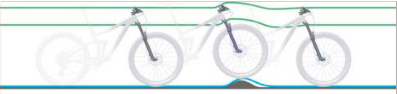
322 paveikslėlis. Per kietas amortizuojančių šakių slopinimas nelygumuose
