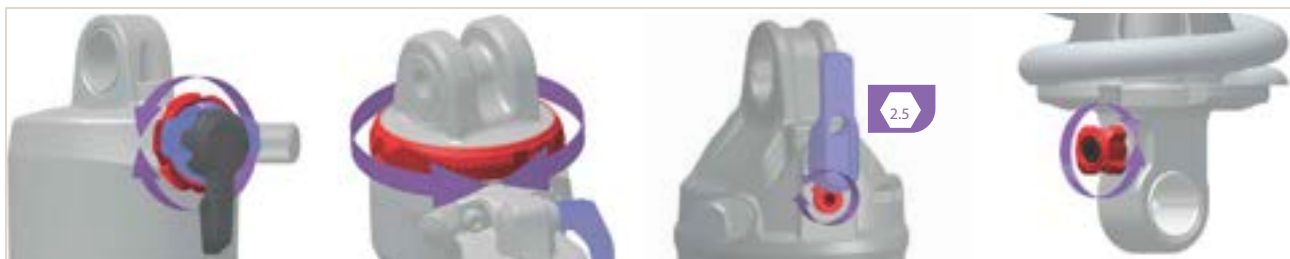
326 paveikslėlis. Atšokimo pakopos reguliatoriaus (raudonos spalvos) padėtis ir forma priklauso nuo modelio
