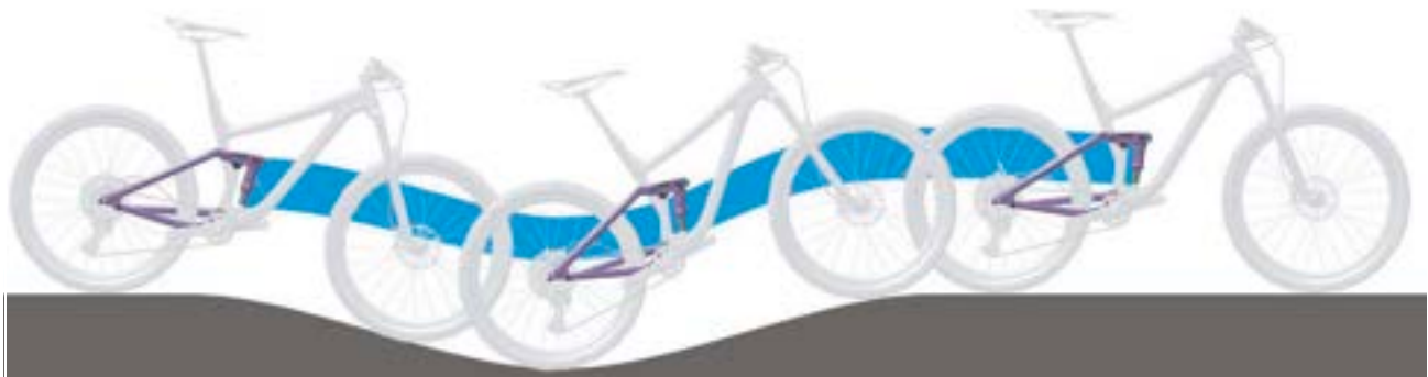
9 paveikslėlis. Optimali galinio amortizatoriaus važiavimo charakteristika kalvotoje vietovėje
