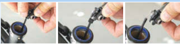
287 paveikslėlis. Bowdeno trosą nuėmimas
