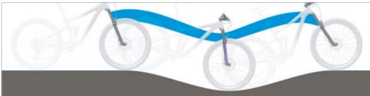
22 paveikslėlis. Optimali amortizuojančios šakės važiavimo charakteristika kalvotoje vietovėje
