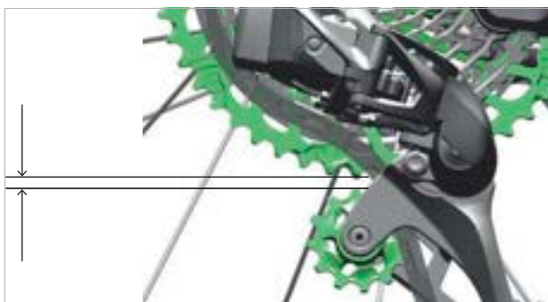
159 paveikslėlis. 3 mm atstumas tarp kreipiamojo ritinėlio ir dantų
