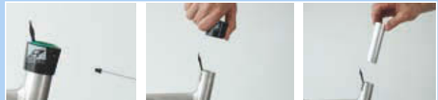
288 paveikslėlis. Išorinės movos ir slankiosios įvorės išmontavimas
