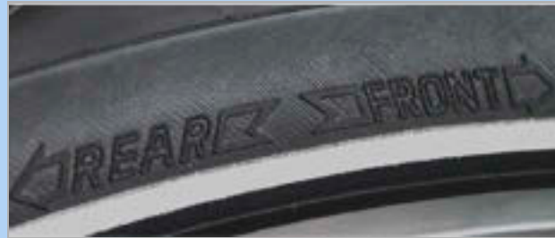
87 paveikslėlis. Krypties rodyklė ant MTB padangų
