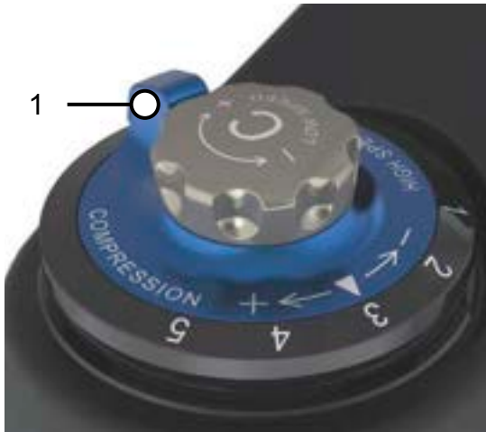
62 lentelė. „SR Suntour“ amortizuojančios šakės didelio greičio svirtis (1) ant karūnėlės
