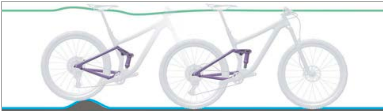
187 paveikslėlis. Optimali galinio amortizatoriaus važiavimo charakteristika važiuojant per nelygumus
