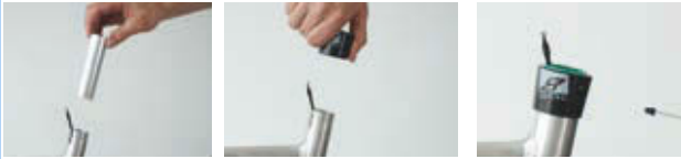
303 paveikslėlis. Slankiosios įvorės ir išorinės movos sumontavimas
