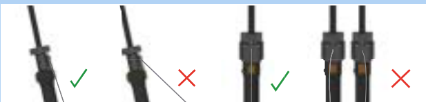
273 paveikslėlis. Tinkamas ir netinkamas Bowdeno trosas
