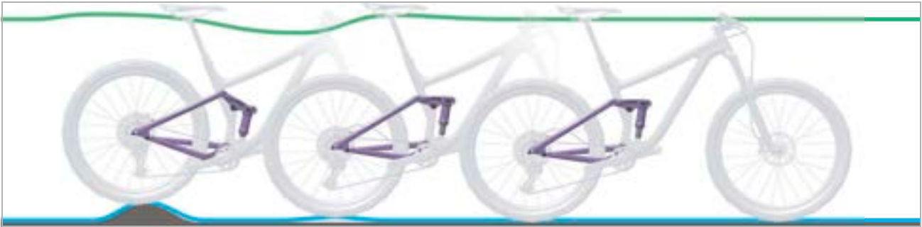
331 paveikslėlis. Per greitas galinio amortizatoriaus atšokimas
