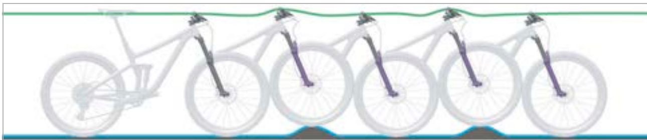
21 paveikslėlis. Optimali amortizuojančio šakės važiavimo charakteristika
