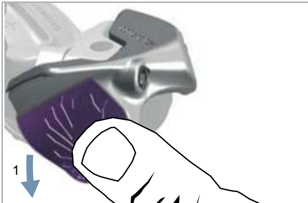
202 paveikslėlis. Perjungimas į aukštesnę pavarą (1)
