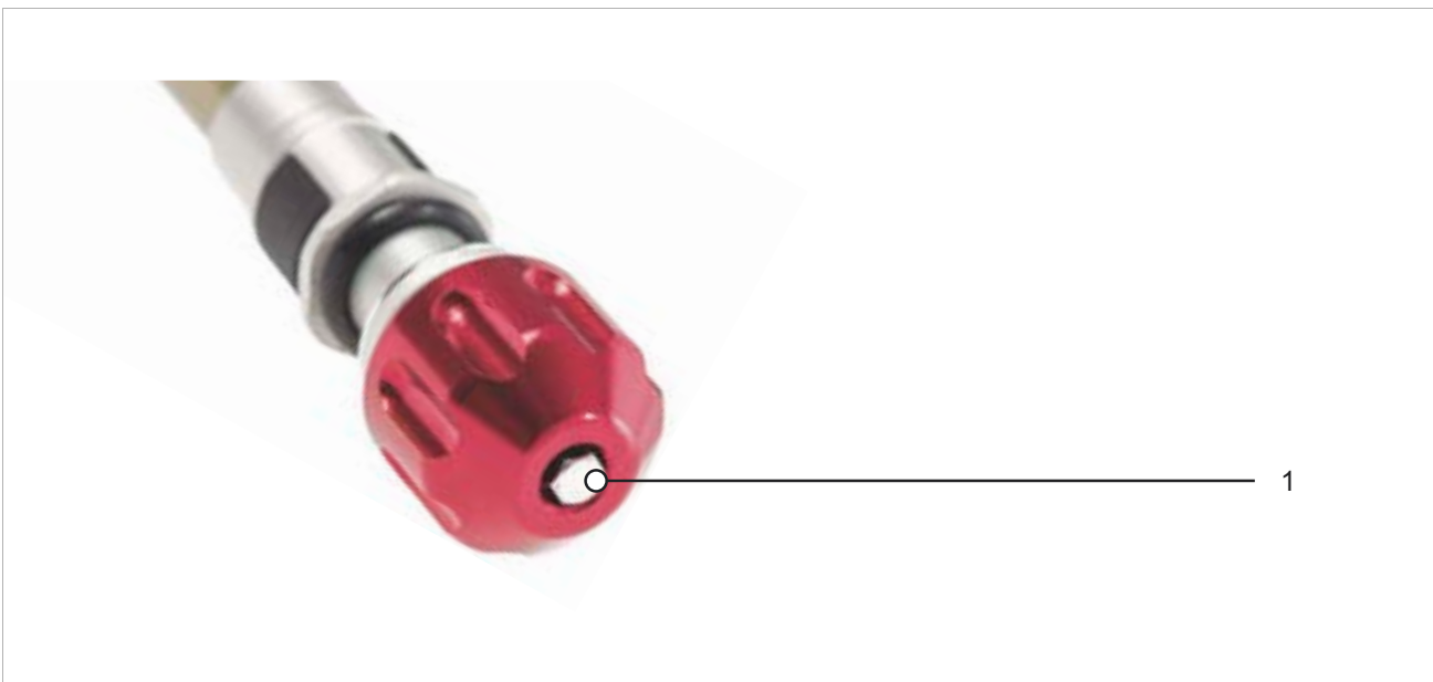
320 paveikslėlis. SR Suntour atšokimo reguliatoriaus (šakė) (1) pavyzdys
