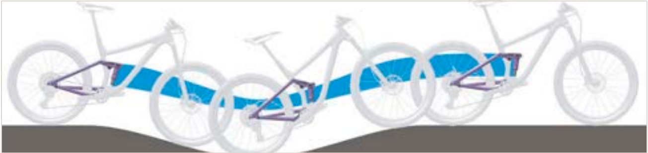
327 paveikslėlis. Per minkštas galinio amortizatoriaus amortizavimas ant kalno
