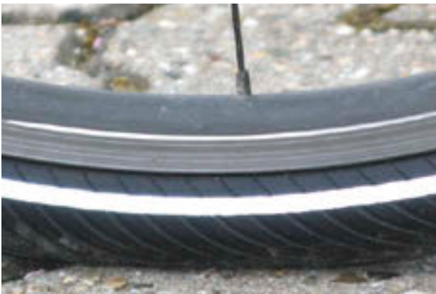
143 paveikslėlis. Tinkamas pripildymo slėgis. Padanga vos deformuota veikiant kūno svoriui
