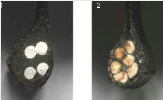
31 paveikslėlis. Plieninė šerdis (1) ir kevlaro šerdis (2)
