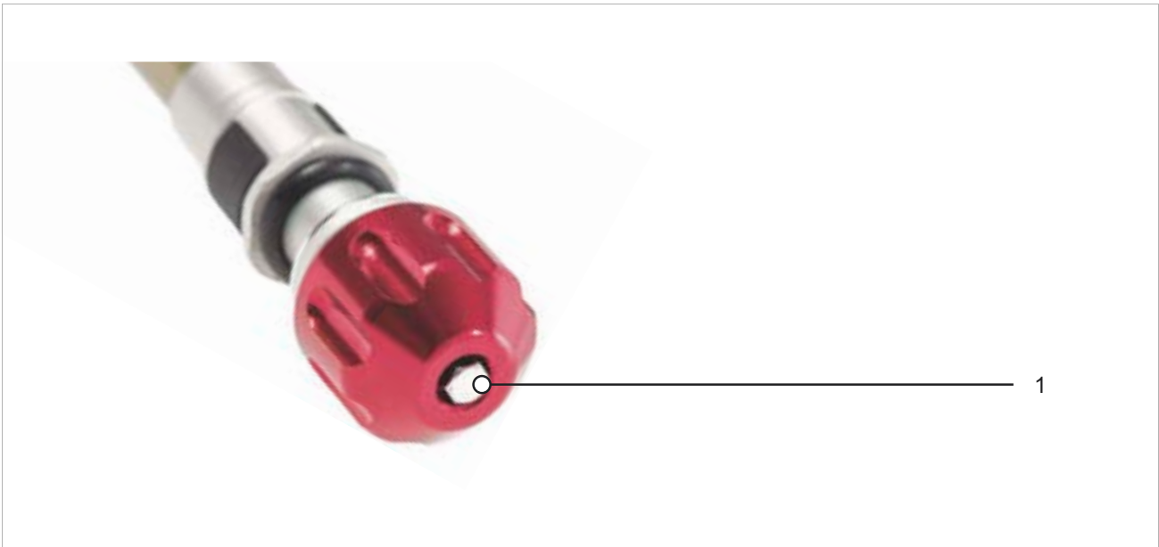
318 paveikslėlis. SR Suntour atšokimo reguliatoriaus (šakė) (1) pavyzdys
