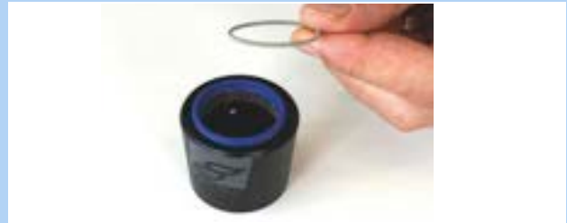
255 paveikslėlis. Nuimta spyruoklinė poveržlė
