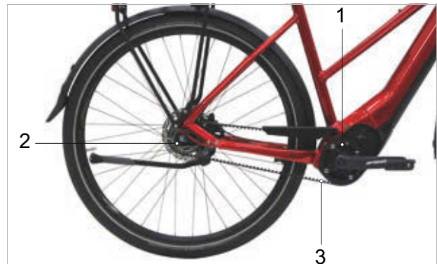
51 paveikslėlis. Diržinės pavaros schema
