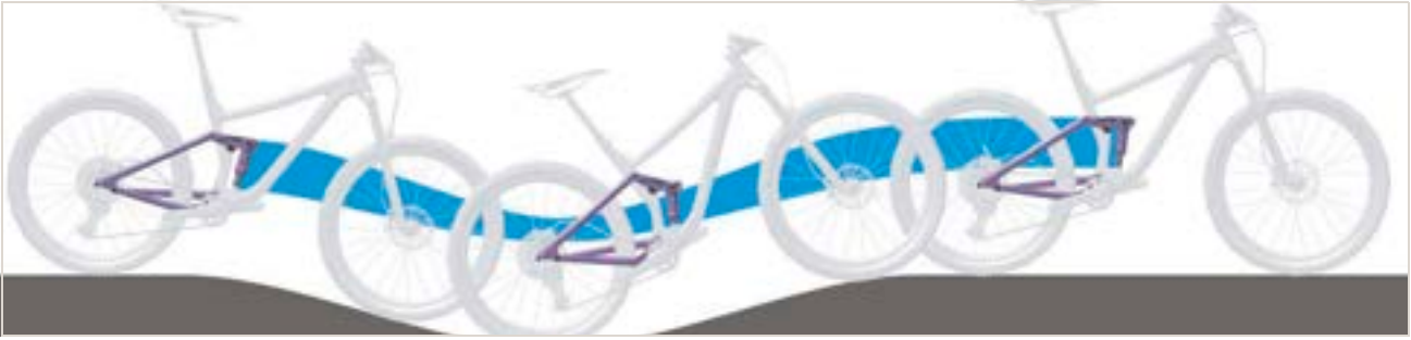
335 paveikslėlis. Ant kalno galinio amortizatoriaus amortizavimas per minkštas
