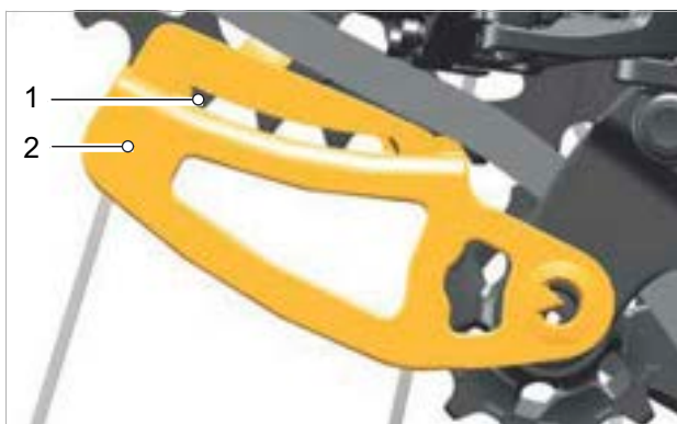
154 paveikslėlis. Lango išpjova (1) su dantimis „Chain Gap“ matavimo šablone (2)
