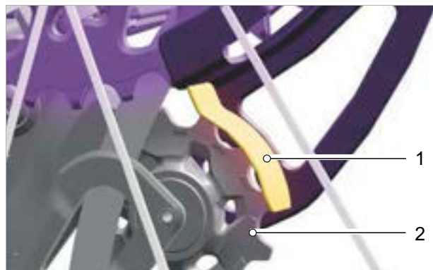
155 paveikslėlis. Liežuvėlis (1) liečia viršutinį kreipiamąjį ritinėlį (2)
