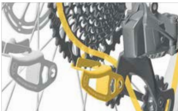
153 paveikslėlis. Grandinė yra ant antro pagal dydį žvaigždžių bloko
