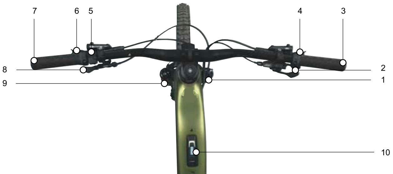
60 paveikslėlis. Vairo su borto kompiuteriu „BOSCH System Controller“ ir valdymo bloku „Mini Remote“ detalus vaizdas, pavyzdys
