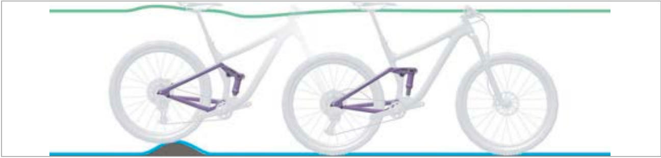
7 paveikslėlis. Optimali galinio amortizatoriaus važiavimo charakteristika važiuojant per nelygumus
