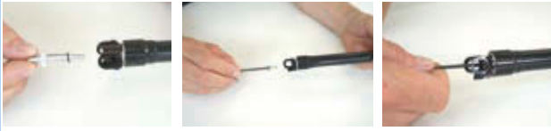
265 paveikslėlis. Kasetės vožtuvo dangtelio pritvirtinimas
