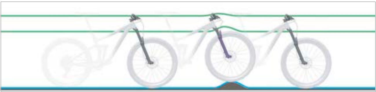
23 paveikslėlis. Optimali amortizuojančios šakės važiavimo charakteristika nelygumuose
