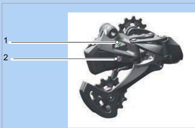
106 paveikslėlis. SRAM XX1 EAGLE AXS pavarų perjungimo mechanizmas su šviesos diodo indikatoriumi (perjungimo svirtis) (1) ir AXS mygtuku (pavarų perjungimo mechanizmas) (2)
