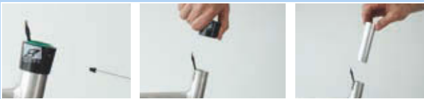
254 paveikslėlis. Išorinės movos ir slankiosios įvorės išmontavimas
