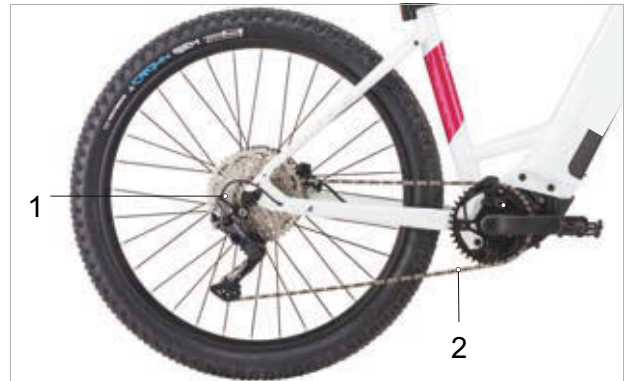
50 paveikslėlis. Grandininės pavaros su pavarų perjungikliu schema
