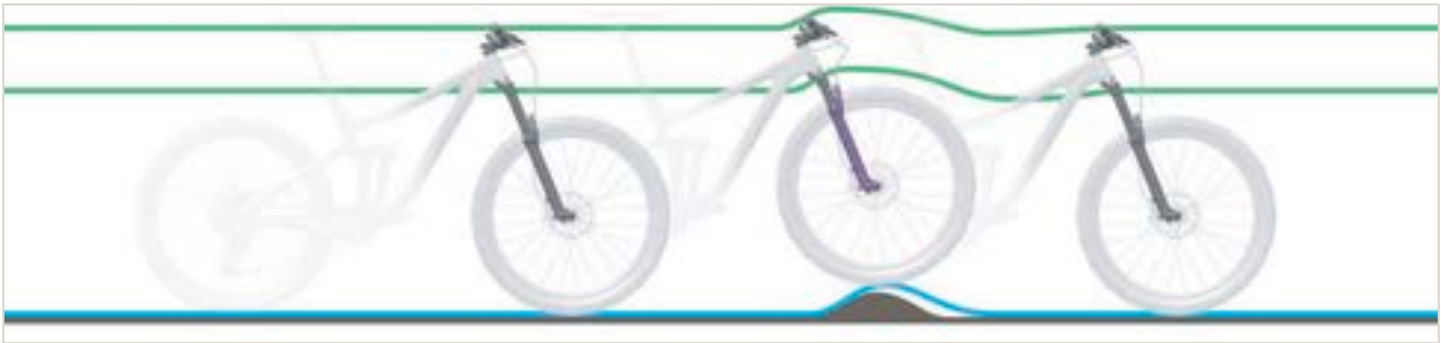
315 paveikslėlis. Per kietas amortizuojančios šakės amortizavimas nelygumuose
