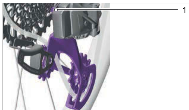
156 paveikslėlis. Nustatymo varžto padėtis (pavarų perjungimo mechanizmo) (1)
