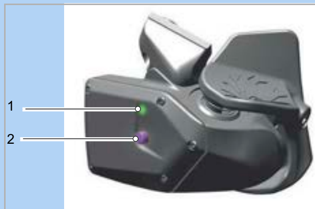
107 paveikslėlis. Pavarų perjungimo mechanizmas „SRAM AXS-Controller“ su šviesos diodo indikatoriumi (perjungimo svirtis) (1) ir AXS mygtuku (pavarų perjungimo mechanizmas) (2)
