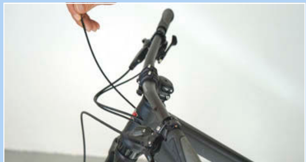
460. ábra: Végsapka beakasztása
