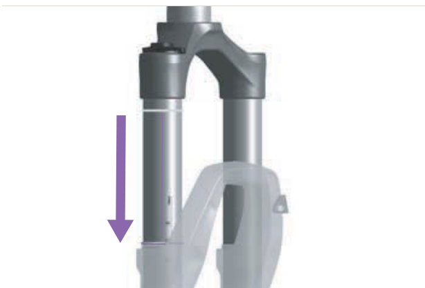
234. ábra: A teleszkópos villa O-gyűrűjének eltolása
