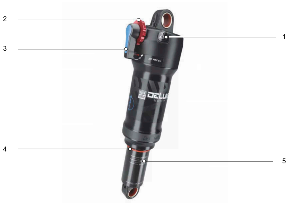
11. ábra: ROCKSHOX Deluxe Select+ hátsó lengéscsillapító felépítés
