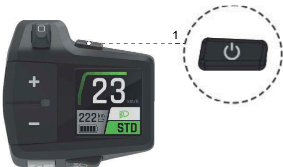
277. ábra: Kijelző (1) a FIT Remote-on LCD-vel
