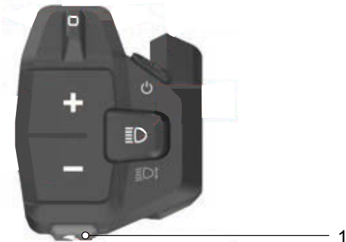
333. ábra: A tolási rásegítés gomb elhelyezkedése
