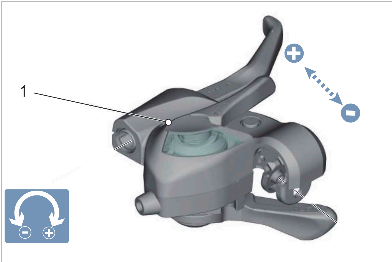
227. ábra: Állítócsavar (1) helyzete
