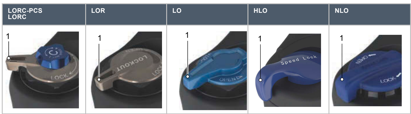
130. táblázat: SR Suntour teleszkópos villa zár a koronán
