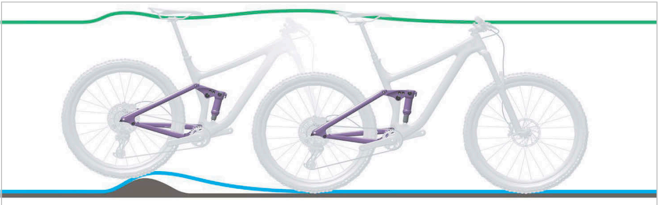
501. ábra: A hátsó lengéscsillapító túl kemény csillapítása egyenetlenségeknél
