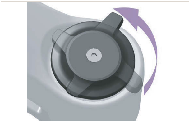
484. ábra: Nyomásfokozat-beállító puhább beállítása
