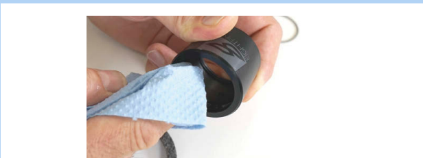
448. ábra: Külső hüvely tisztítása
