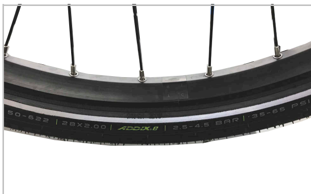
42. ábra: Példa: Információk a gumibroncon
