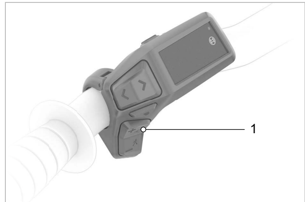
329. ábra: A világítás gomb elhelyezkedése (1)
