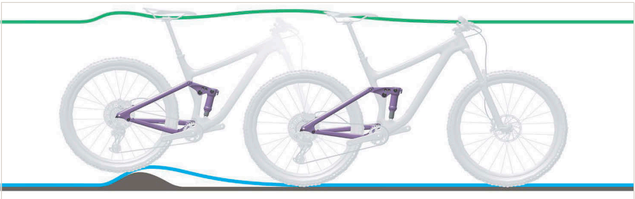
517. ábra: A hátsó lengéscsillapító túl kemény csillapítása egyenetlenségeknél
