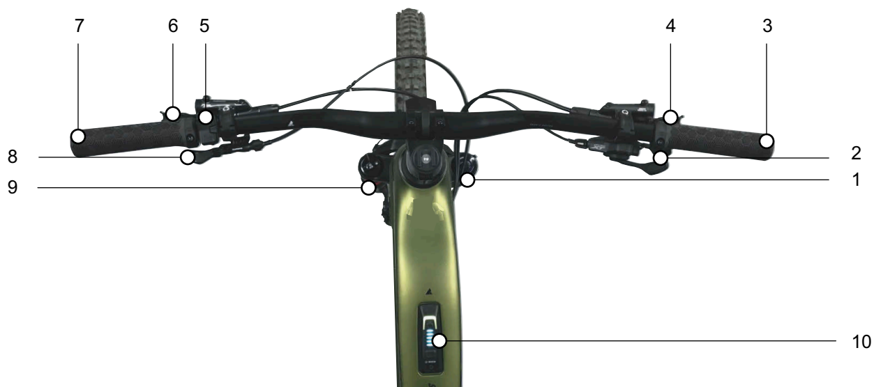
121. ábra: Kormány Bosch rendszervezérlő fedélzeti számítógéppel és Mini Remote kezelőegységgel részletes nézet, példa
