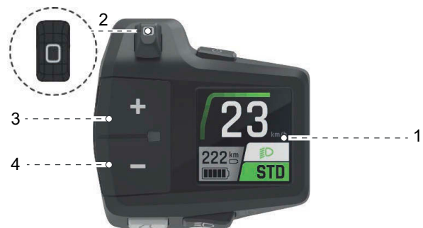
278. ábra: Kijelző (1) a FIT Remote-on LCD-vel
