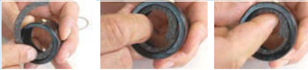
414. ábra: Filcgyűrű behelyezése
