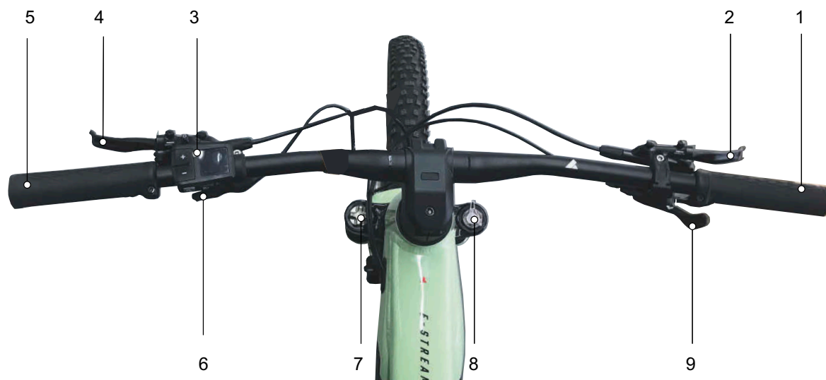
146. ábra: FIT LED Remote fedélzeti számítógéppel felszerelt kormány részletes nézete, példa
