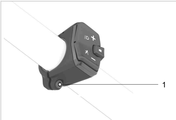
520. ábra: A rögzítőcsavar elhelyezkedése
