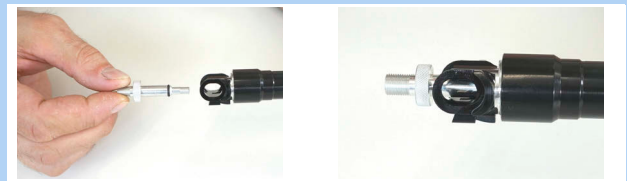
418. ábra: Szelepadapter becsavarozása
