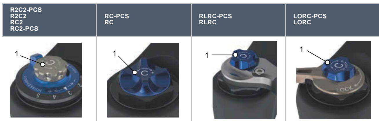
186. táblázat: Az SR Suntour teleszkópos villa Low-Speed karja (1) a villakoronán
