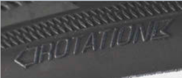
170. ábra: Futásirányjelző nyíl
