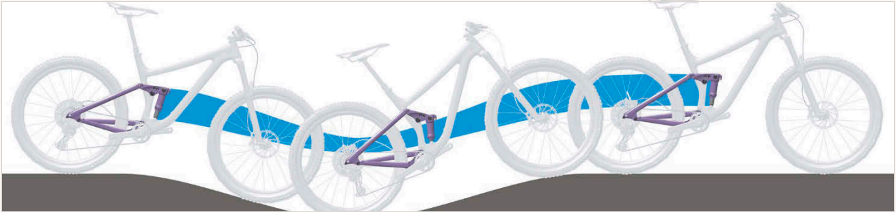
515. ábra: A hátsó lengéscsillapító túl puha rugózása hegymenetben
