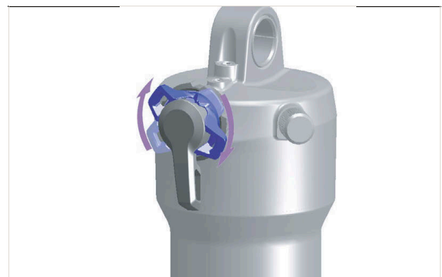
314. ábra: Nyomásfokozat-beállító beállítása keményebbre
