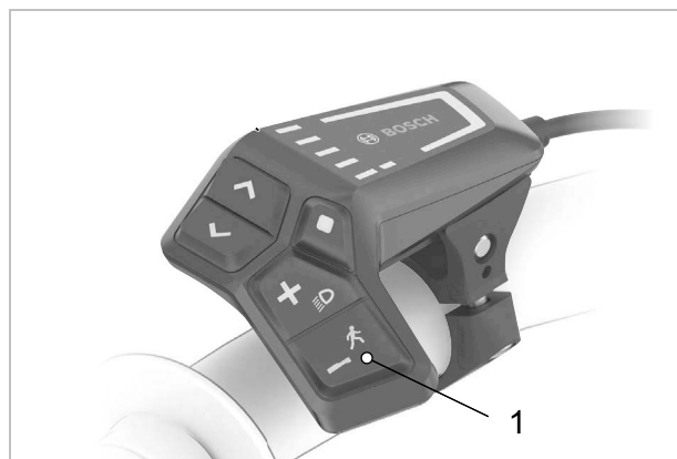
326. ábra: A tolási rásegítés gomb elhelyezkedése (1)
