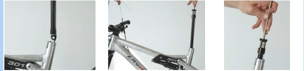
429. ábra: Tubus szelepfedél rögzítése
