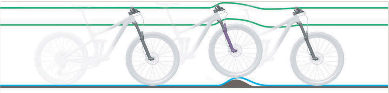
492. ábra: A teleszkópos villa túl kemény csillapítása egyenetlenségeknél
