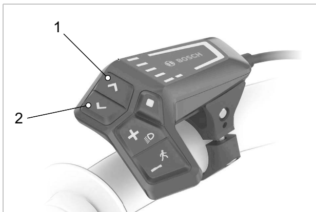
325. ábra: A fényerő növelése gomb (2) és fényerő csökkentése gomb (1) elhelyezkedése
