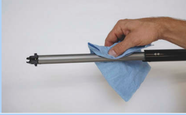
454. ábra: Hosszirányú vezetőhorony tisztítása
