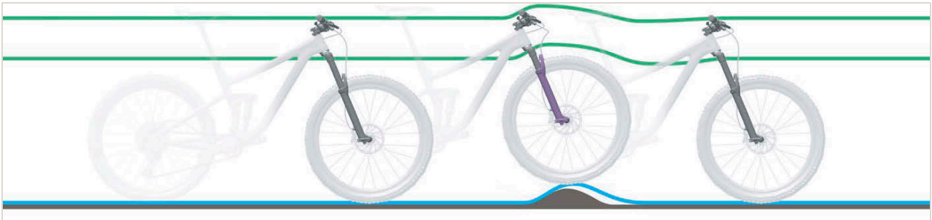
483. ábra: A teleszkópos villa túl kemény csillapítása egyenetlenségeknél
