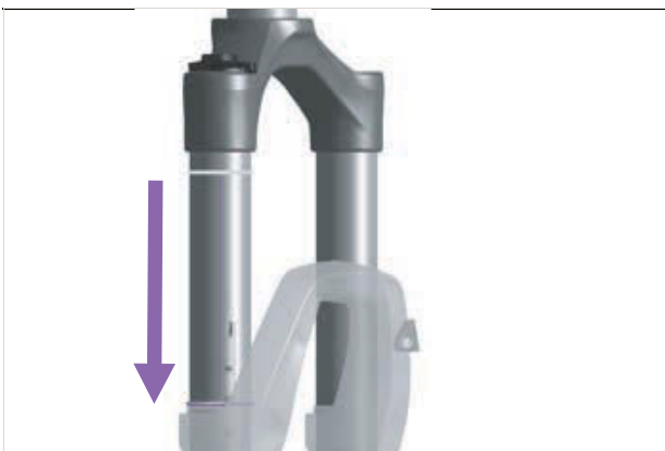
237. ábra: Az O-gyűrű eltolása a teleszkópos villán
