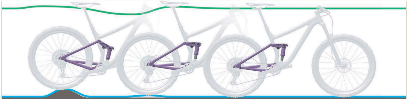
511. ábra: A hátsó lengéscsillapító túl gyors kirugózása
