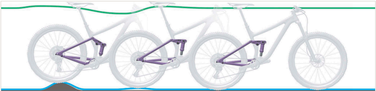
503. ábra: A hátsó lengéscsillapító túl gyors kirugózása
