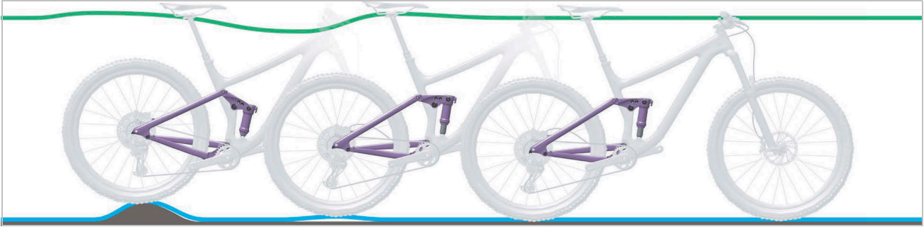
495. ábra: A hátsó lengéscsillapító túl gyors kirugózása
