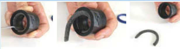
447. ábra: A filcgyűrű eltávolítása
