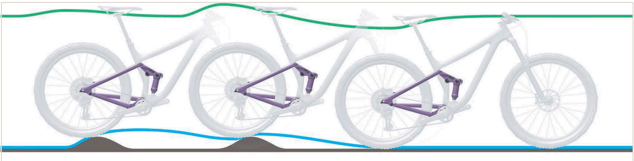
513. ábra: A hátsó lengéscsillapító túl lassú kirugózása
