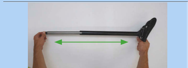
453. ábra: Nyeregcső széthúzása
