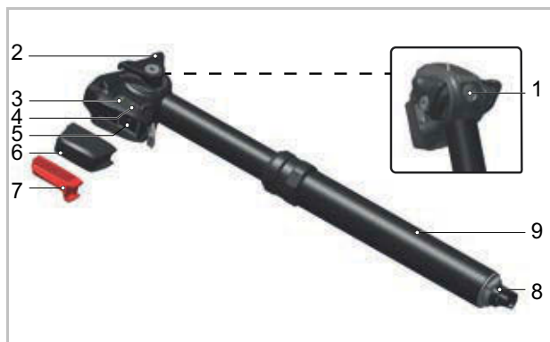
70. ábra: ROCKSHOX Reverb AXS nyeregcső felépítése
