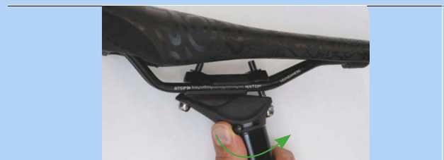
452. ábra: Magasságállítás nyitása
