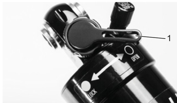
Illustration 75 : Dispositif de réglage de la compression Suntour ouvert (1)
