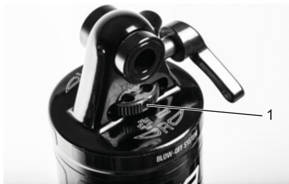
Illustration 59 : Molette de réglage de la détente Suntour (1) sur l'amortisseur arrière
