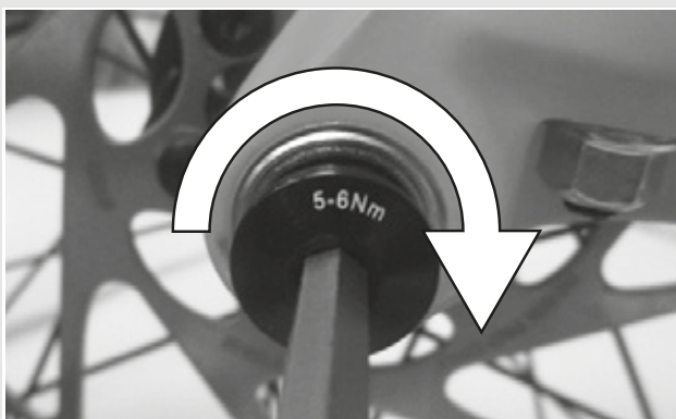
Illustration 26 : Serrer la vis de blocage
