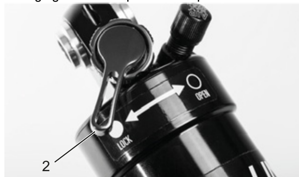
Illustration 76 : Dispositif de réglage de la compression Suntour fermé (2)
