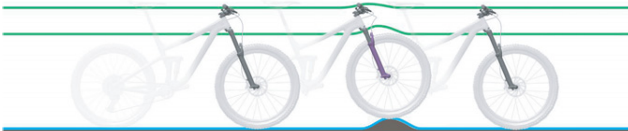
10. ábra: A villa optimális menetviselkedése egyenetlenségek esetén
