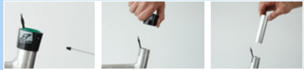
172. ábra: Külső hüvely és siklópersely kiszérése
