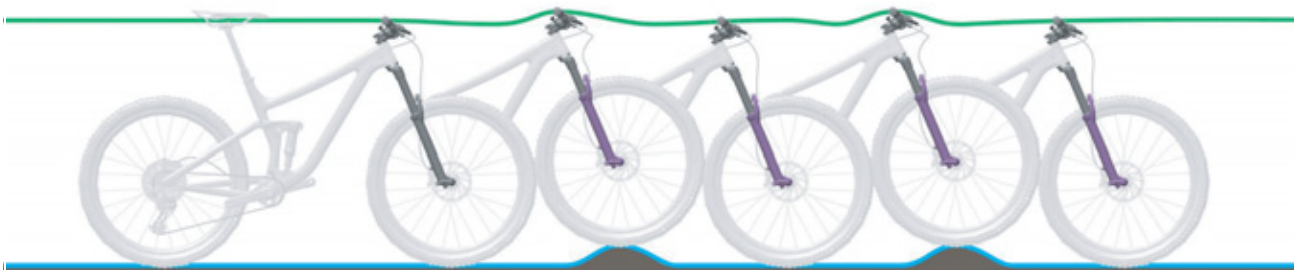
83. ábra: A villa optimális menetviselkedése
