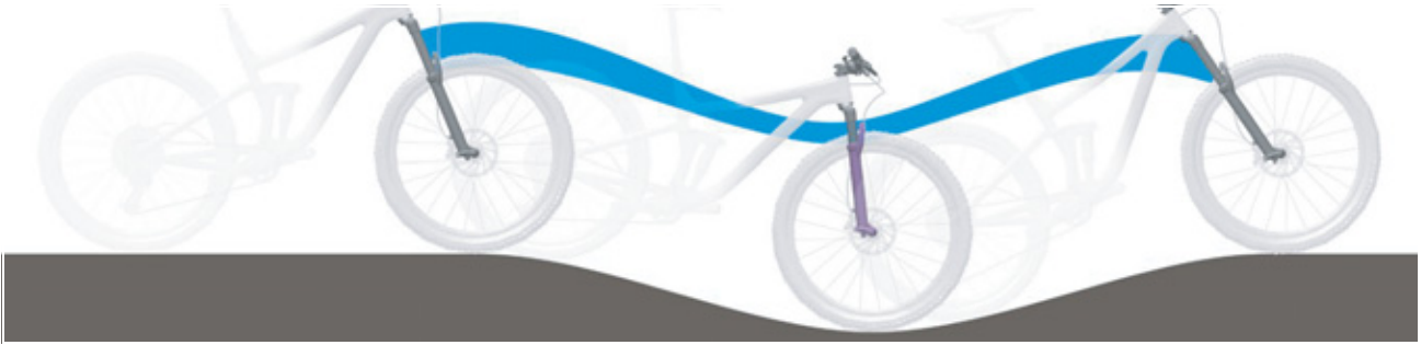
196. ábra: A teleszkópos villa túl puha rugózása hegymenetben
