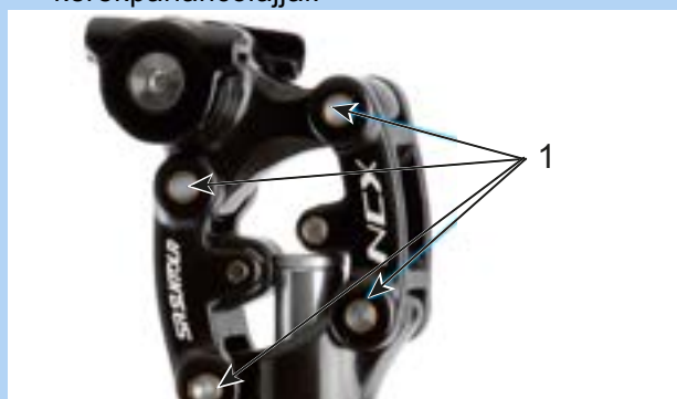
129. ábra: SR kenőpontok Suntour rugós nyeregcső
