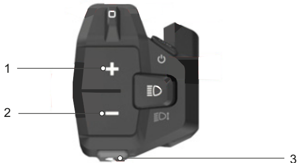
104. ábra: A plusz (1), mínusz (2) és tolási rásegítés (3) gombok elhelyezkedése
