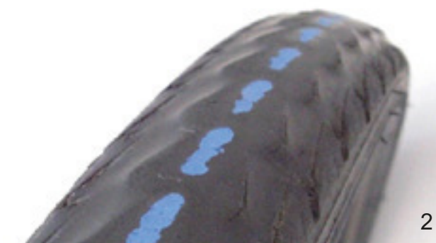
117. ábra: Profil nélküli gumiabroncs, amivel még kerékpározni lehet (1), és cserélendő gumiabroncs áttetsző defektvédelemmel (2)
