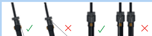
Abbildung 176: Korrekter und falscher Bowdenzug
