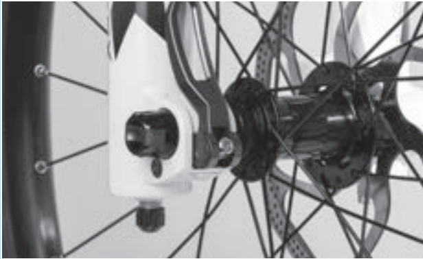
Abbildung 146: Spannkraft des Schnellspanners einstellen
