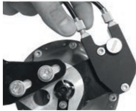
Abbildung 143: ROHLOFF-Naben Versionen mit externer Schaltansteuerung haben die Zugeinsteller an der Seilbox, die sich auf der linken Seite befindet
