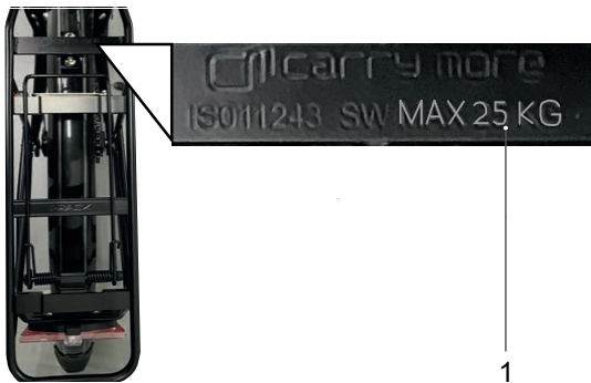
Abbildung 116: Auf dem Gepäckträger ist seine maximale Tragfähigkeit (1) ausgewiesen.
