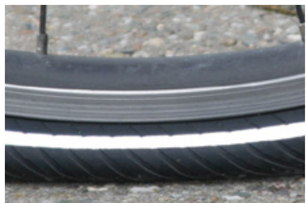
Figura 84: Presión de inflado demasiado baja
