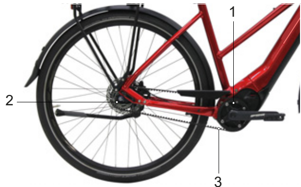
Figura 33: Esquema de la transmisión por correa
