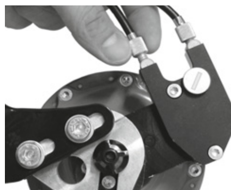
Figura 138: Las versiones de bujes Rohloff con activación de cambio externa tienen los dispositivos de ajuste de tensión en la caja de cables que se encuentra en el lado izquierdo
