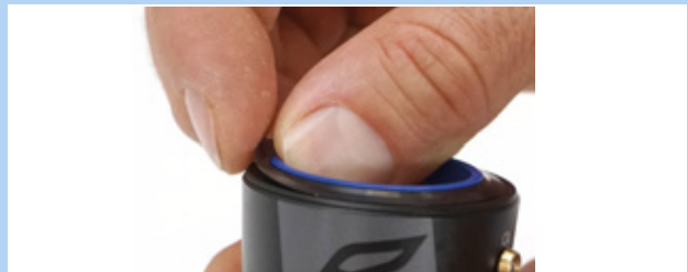
Figura 188: Retirada del anillo con falda de obturación
