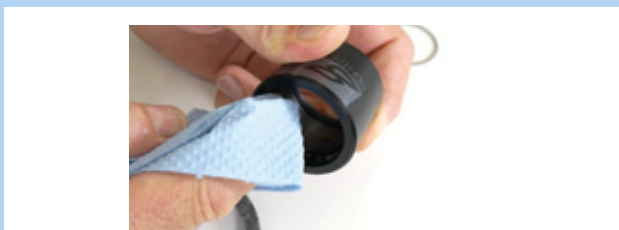
Figura 192: Limpieza del manguito exterior
