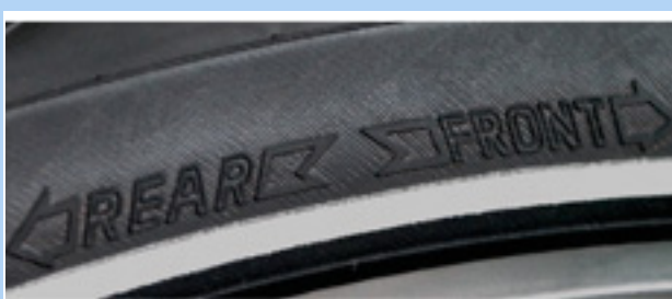
Figura 60: Flecha de sentido de la marcha en cubiertas de MTB
