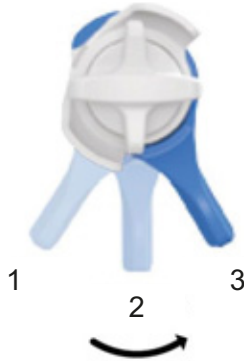
Figura 97: Ajuste de la palanca de 3 vías desde la posición cerrada (1), pasando por la posición media (2) hasta la posición abierta (3)
