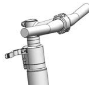
Figura 127: All Up con palanca tensora de la potencia abierta
