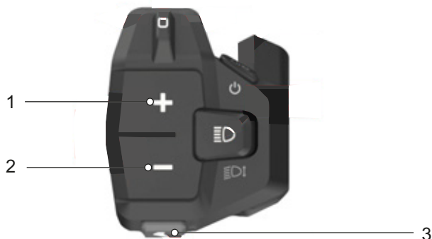
Figura 121: Posición del botón + (1), del botón - (2) y del botón de ayuda para el desplazamiento (3)
