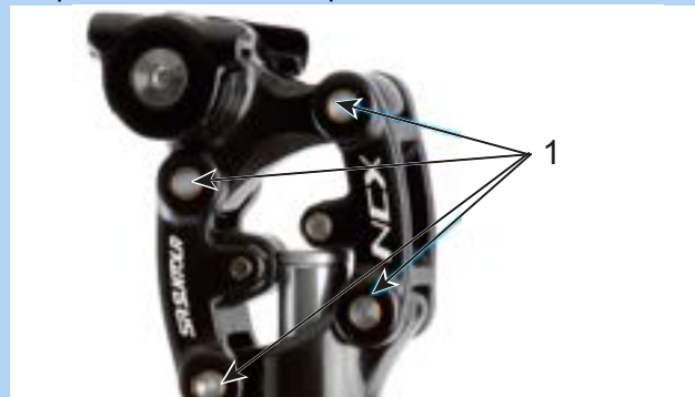
Figura 146: Puntos de lubricación de la tija de sillín de muelle SR Suntour
