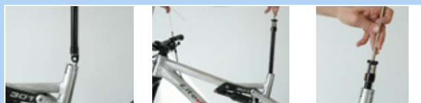
Figura 175: Fijación la tapa de la válvula del cartucho
