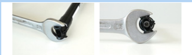
Figura 168: Aseguramiento para evitar el giro
