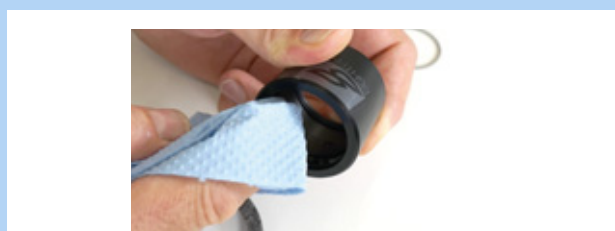
Figura 159: Limpieza del manguito exterior
