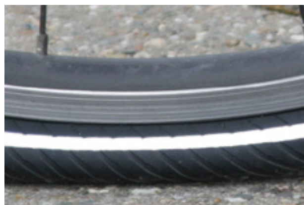
Figura 92: Presión de inflado demasiado baja
