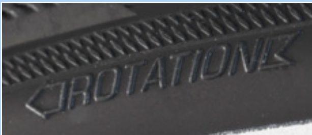
Figura 67: Flecha de sentido de la marcha
