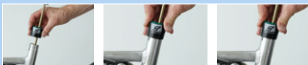
Figura 179: Inserción del manguito exterior
