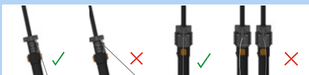
Figura 174: Cable Bowden correcto e incorrecto
