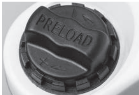
Abbildung 55: Einstellrad des Negativfederwegs auf der Krone der Federgabel
