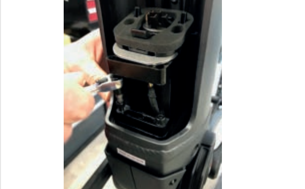
Abbildung 23: 4 mm 6-Kant-Schrauben entfernen
