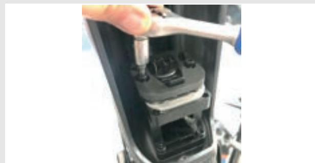
Abbildung 22: Akkuhalter Schrauben lösen
