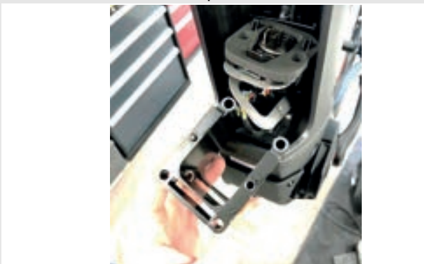
Abbildung 25: PowerTube Adapter herausziehen
