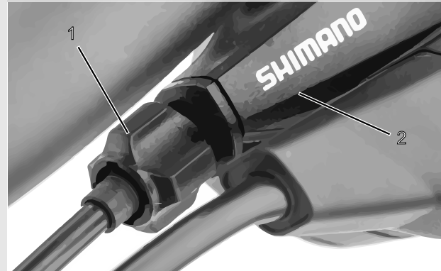
Abbildung 69: Einstellhülse (1) der einzügigen, seilzugbetätigten Gangschaltung mit Schalthebelgehäuse (2), Beispiel
