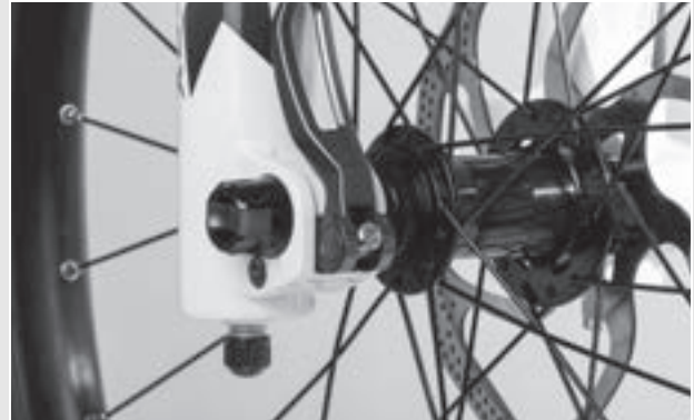
Abbildung 38: Perfekte Lage des Spannhebels
